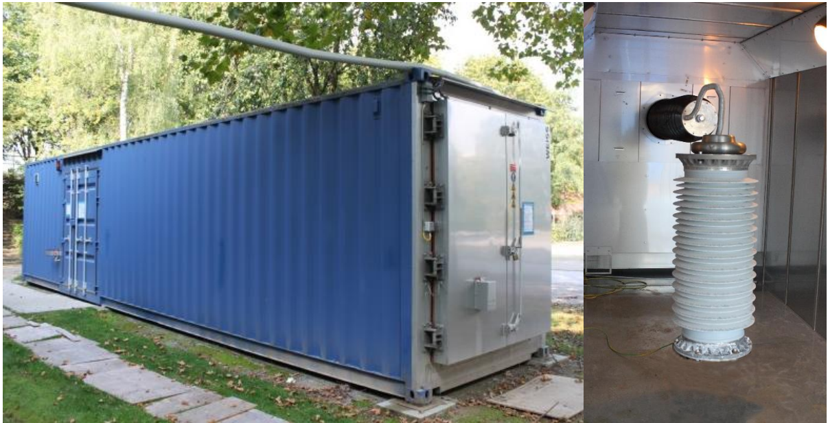
Abbildung 15: Klimakammer. Außenansicht (links) und Sicht in den Prüfungsraum mit exemplarischem Hochspannungsisolator als Prüfling (rechts)
