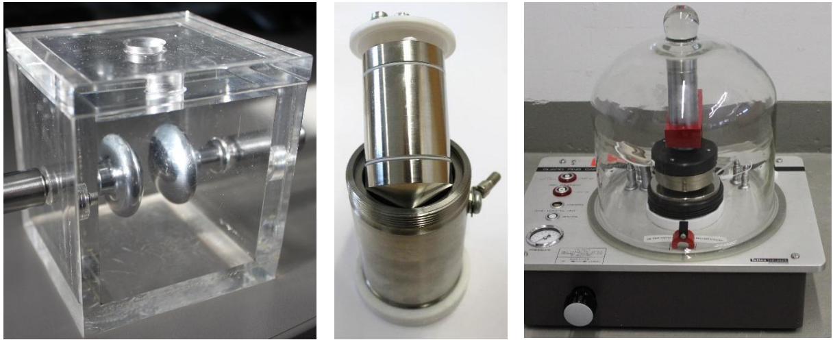
Abbildung 17: Anordnungen zur Materialuntersuchung: Kugelkalotten zur Bestimmung der Durchschlagsspannung von Flüssigkeiten (links), Schutzring-Anordnung zur \tan \delta -Messung von Flüssigkeiten (mittig), Messzelle zur Bestimmung des \tan \delta von Feststoffen
