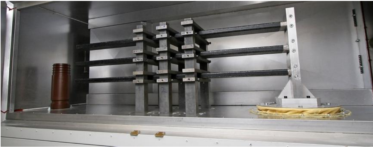
Abbildung 14: Innenraum der Wechselbiegeanlage. Waagrecht drei in die Anlage eingespannte Generatorstäbe
