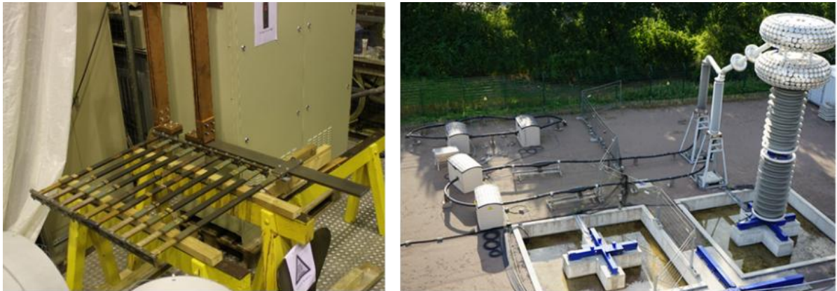
Abbildung 8: 4000 A-Hochstromprüfanlage, hier Einsatz zur thermischen Alterung von Generatorstabilisiersystemen auf Teststäben (links), Heat Cycle Tests System (HCTS) in Anwendung zur thermischen Belastung von Hochspannungskabeln
